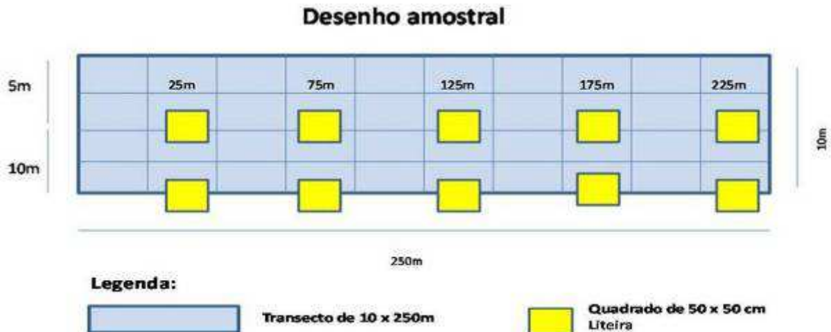
Figura 7. Desenho esquemático mostrando os detalhes da coleta de serrapilheira. (Fonte: Rede Amazônia Sustentável)
